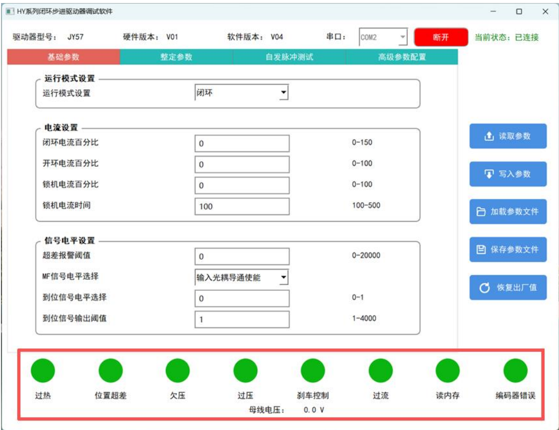
图 9-1 状态监控模块图示
