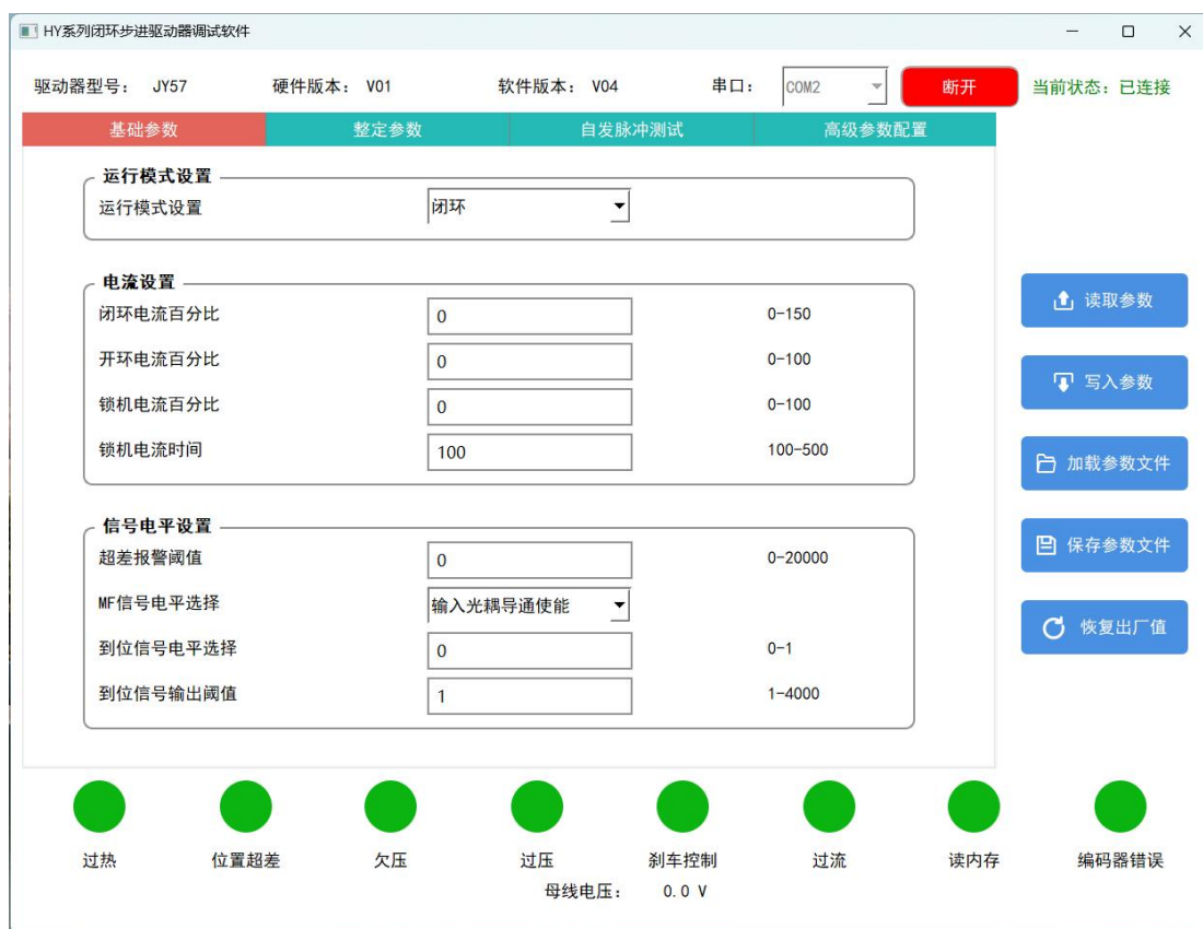
图 4-1 基础参数配置页面图示
