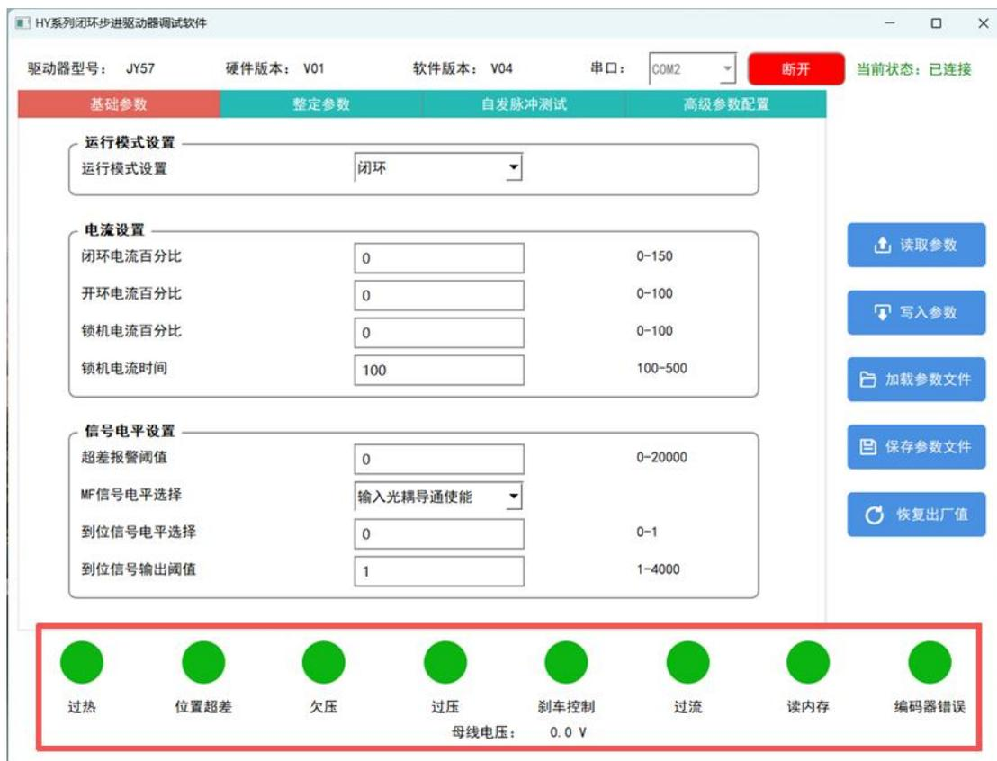
图 9-1 状态监控模块图示
