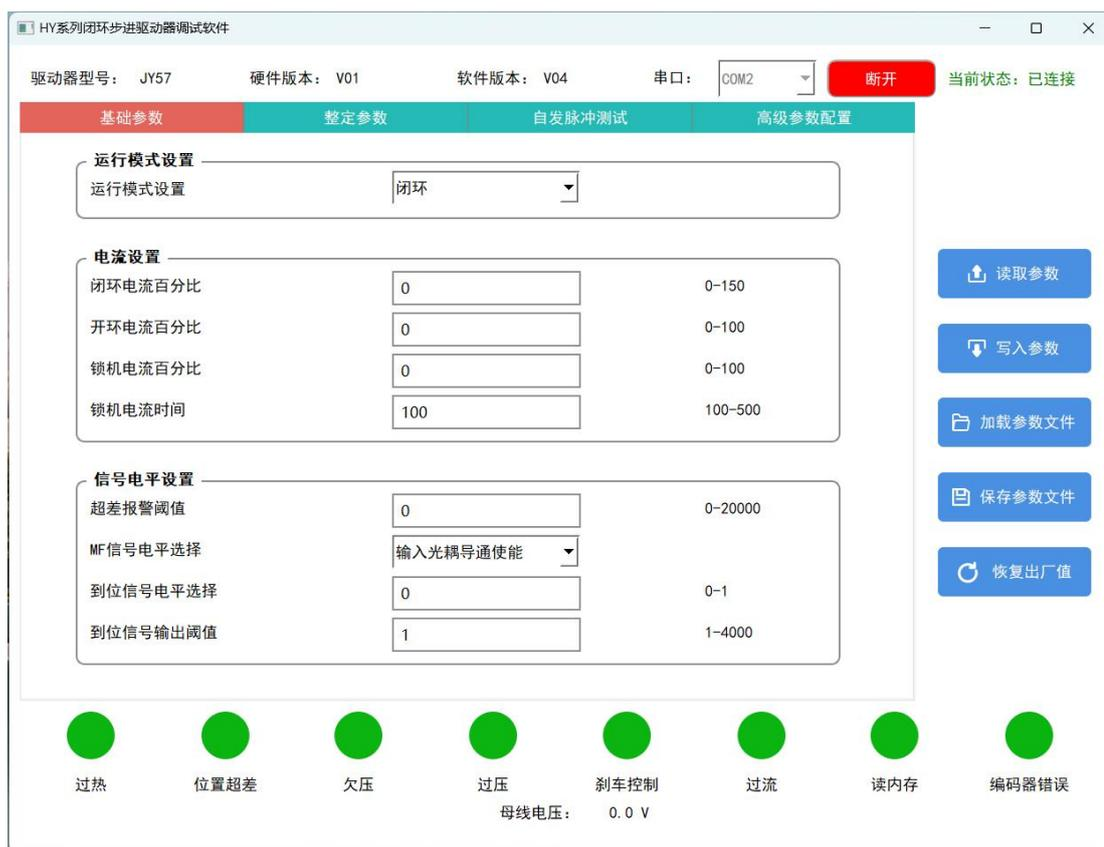
图 4-1 基础参数配置页面图示
